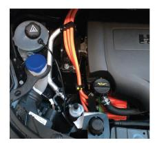
Les véhicules électriques et hybrides sont soumis à une maintenance régulière. La présence de haute tension nécessite que l'intervenant soit formé aux risques électriques afin de ne pas mettre sa vie en danger.
