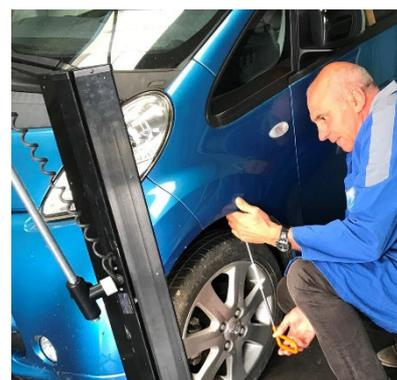
Le débouurrage est **une technique de débousselage qui s'inspire du « débousselage sans peinture »** en mobilisant les mêmes outils. Il propose **une alternative aux techniques traditionnelles** (tas/marteau et tire-clous) et consiste à redresser 80 à 90 % d'une bosse avant peinture. Le débouurrage est possible sur tous les éléments s'il y a un accès direct ou peu de démontage nécessaire.
