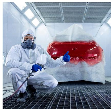
La démocratisation des **teintes multicouches** en industrie automobile **modifie les techniques d'application** en réparation. **L'activité du peintre se complexifie** car la mise en peinture d'un seul élément devient presque impossible en terme colorimétrique.
